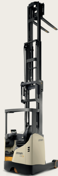
ESR / Reach Truck Yükleme Kapasitesi 1600 kg -2000 kg Kaldırma Yüksekliği 10.700 – 11.435 mm
