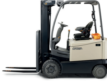
FC / 4 Tekerli Akülü Forklift Taşıma Kapasitesi: 2500-3000 kg Kaldırma Yüksekliği 4825 - 6120 mm
