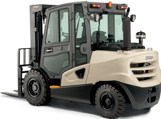
CD 30 -35 Dizel Forklift Kaldırma Kapasitesi: 3000-3500 kg Kaldırma Yüksekliği 3000 mm - 6150 mm
