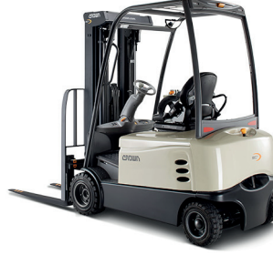
SCF / 4 Tekerli Akülü Forklift Taşıma Kapasitesi: 1600-2000 kg Kaldırma Yüksekliği 4825 - 6120 mm
