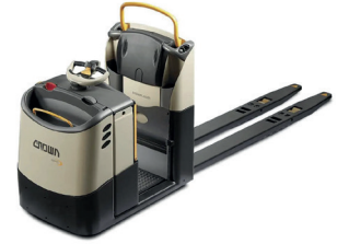
GPC / Sabit Platformlu Sipariş Toplayıcı Taşıma Kapasitesi: 2000 kg 1600 -1800 - 2400 mm Çatal Seçenekli
